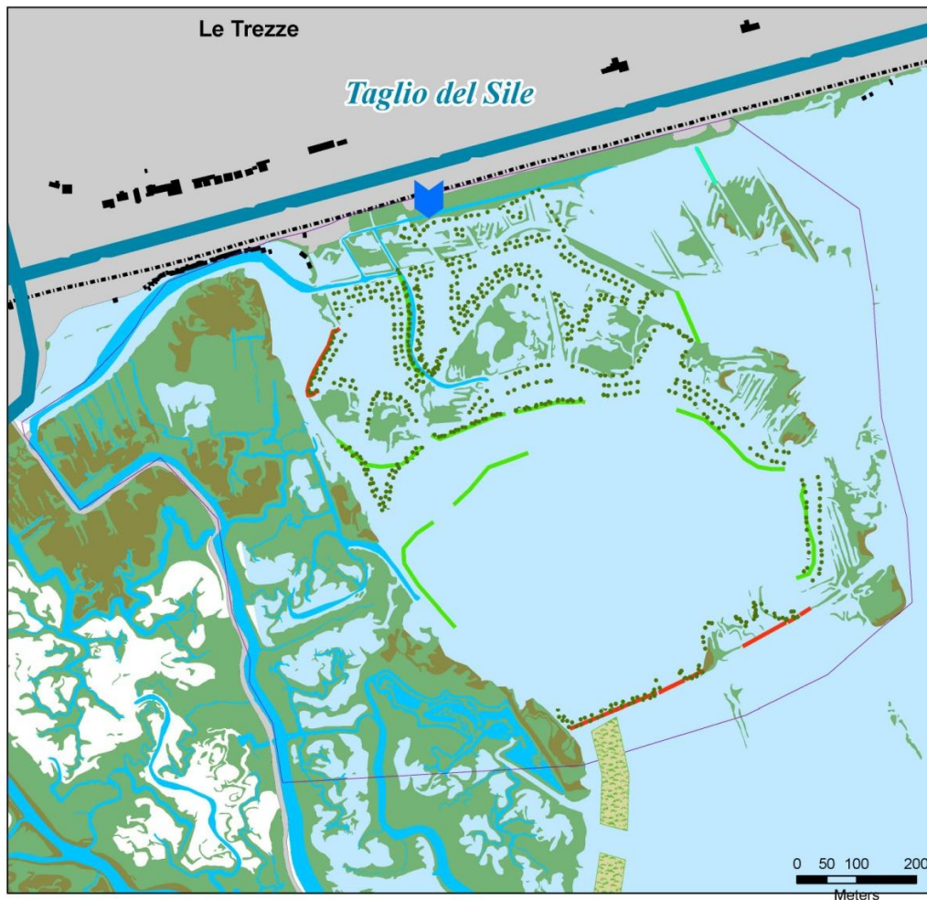
Figura 2. Interventi previsti dal progetto LIFE LAGOON REFRESH: dettaglio della zona di immissione dell'acqua dolce dal fiume Sile in laguna.
