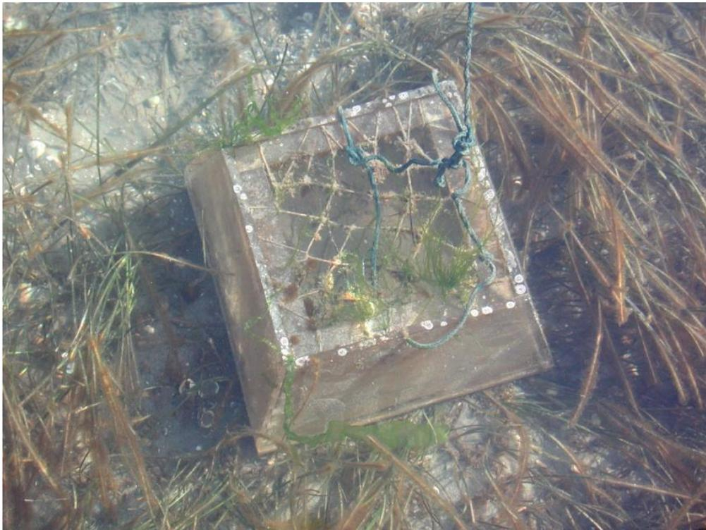
Figura 9. Trappola di sedimentazione in una prateria di *Cymodocea nodosa* durante la stagione invernale.
