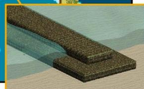
Ripristino di morfologia intertidale con strutture modulari biodegradabili
