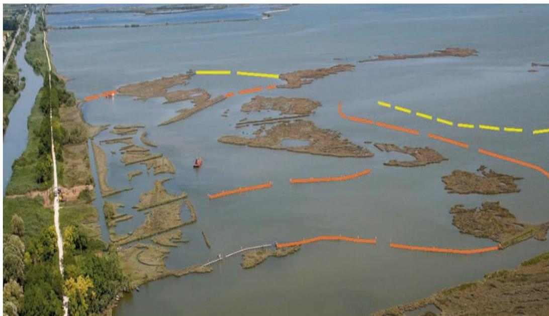
Figura 3. Vista aerea dell'area di progetto con indicazione della localizzazione delle strutture morfologiche di primo stralcio (in arancione) e di secondo stralcio (in giallo).
